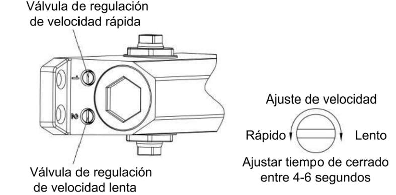
2 Válvula de regulación rápida Rango 15-0°
